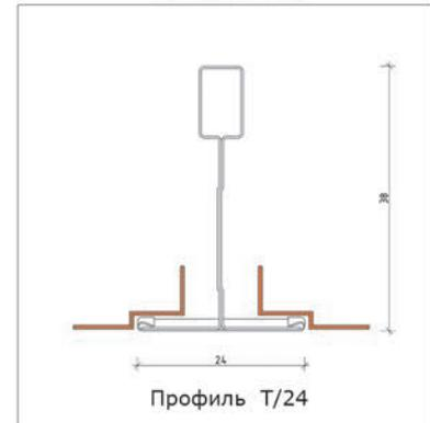
Панели устанавливаются в видимую подвесную систему, состоящую из металлических Т-образных самофиксирующихся направляющих. Они образуют ячейки, в которые укладываются панели соответствующих размеров. Расстояние от подвесной системы до потолка зависит от оборудования, которое необходимо разместить в запотолочном пространстве, минимальная высота подвеса – 120 мм. Видимая сторона направляющих имеет декоративное цветное покрытие, выполненное в заводских условиях.
