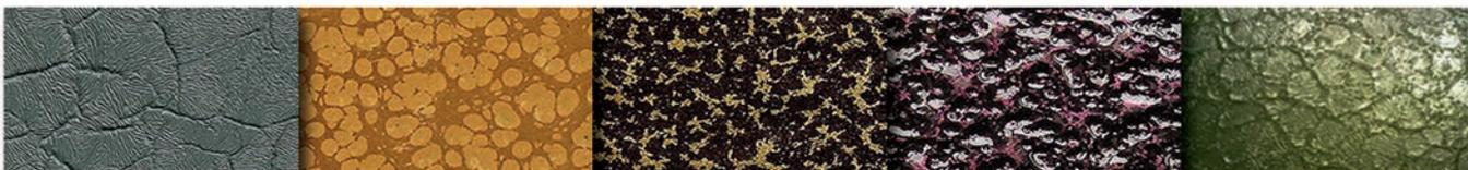
**Термостойкое порошковое покрытие** основано на силиконовых смолах, имеет хорошую устойчивость к ультрафиолетовым лучам и высокую стойкость к постоянно высоким температурам (до 500°C). Изделия с таким покрытием может быть в двух цветах: серый и черный металл.
