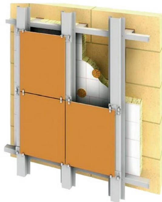
1. Плита фасадная – керамика, керамогранит S=7-12мм
