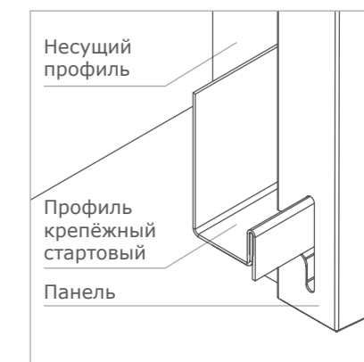
Узел примыкания системы к полу
